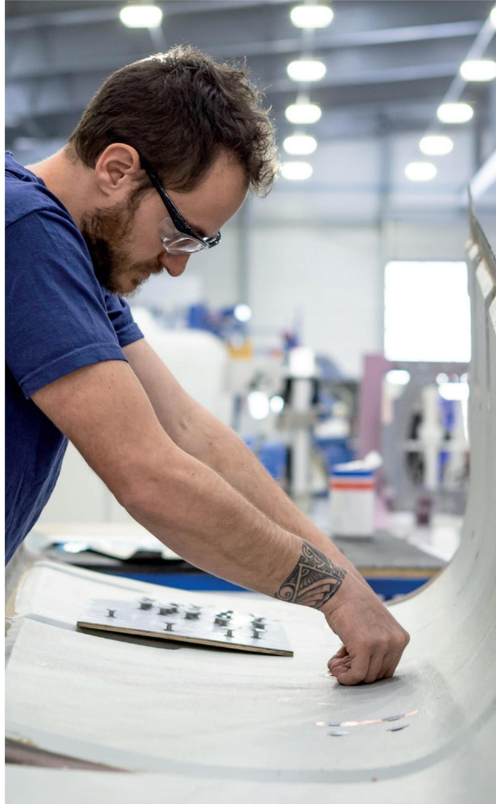
Scellement d'inserts sur une poutre de queue Airbus H160.
