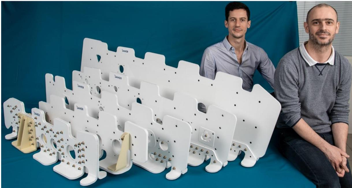
*Nervures – pièces de structure fortement sollicitées à l’effort, de grande dimension et complexes, avec une épaisseur variable en fonction des zones – réalisées dans le cadre du programme « Wing of tomorrow » d’Airbus visant à développer la prochaine génération d’aile pour avion monocouloir*
